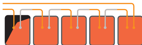
CONEXION EN SERIE: Todos los módulos producen como el peor del conjunto. Hay pérdidas por mismatch y sombreado parcial.
